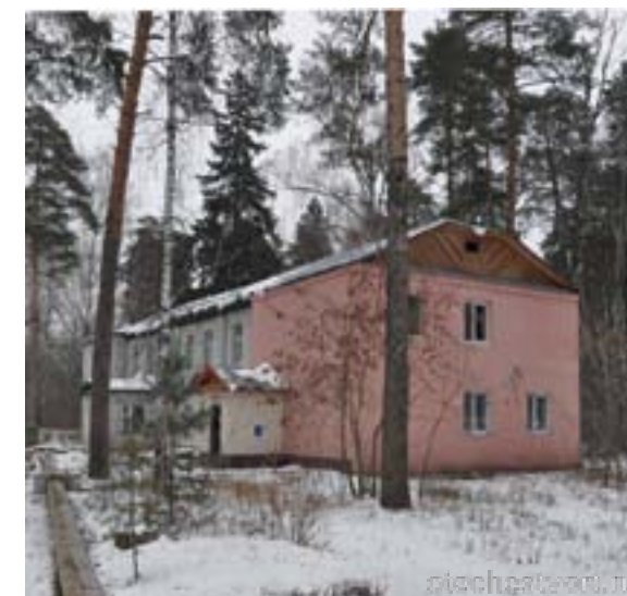
Еще один из сохранившихся с военных лет корпусов обложен поверх деревянных стен кирпичом, ремонтируется.
