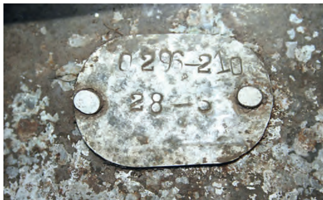
Бирка с сокращенным заводским номером самолета – 28-5
